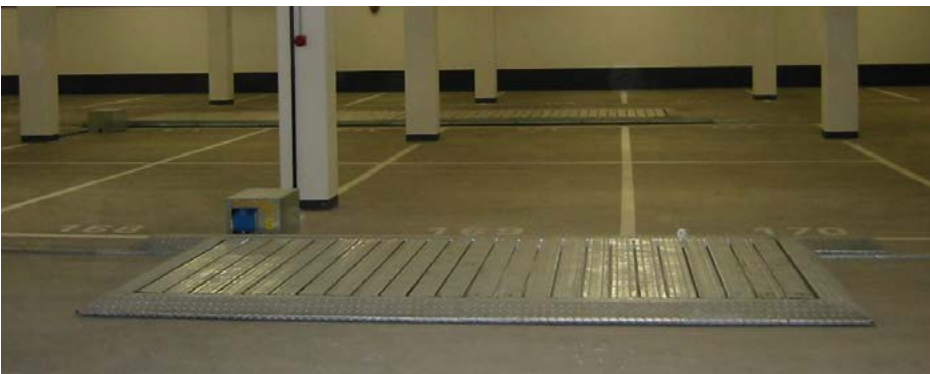
Verschiebepalette HLE mit Überflur-Antrieb, Stellplatzbelag aus Trapezblechen.
